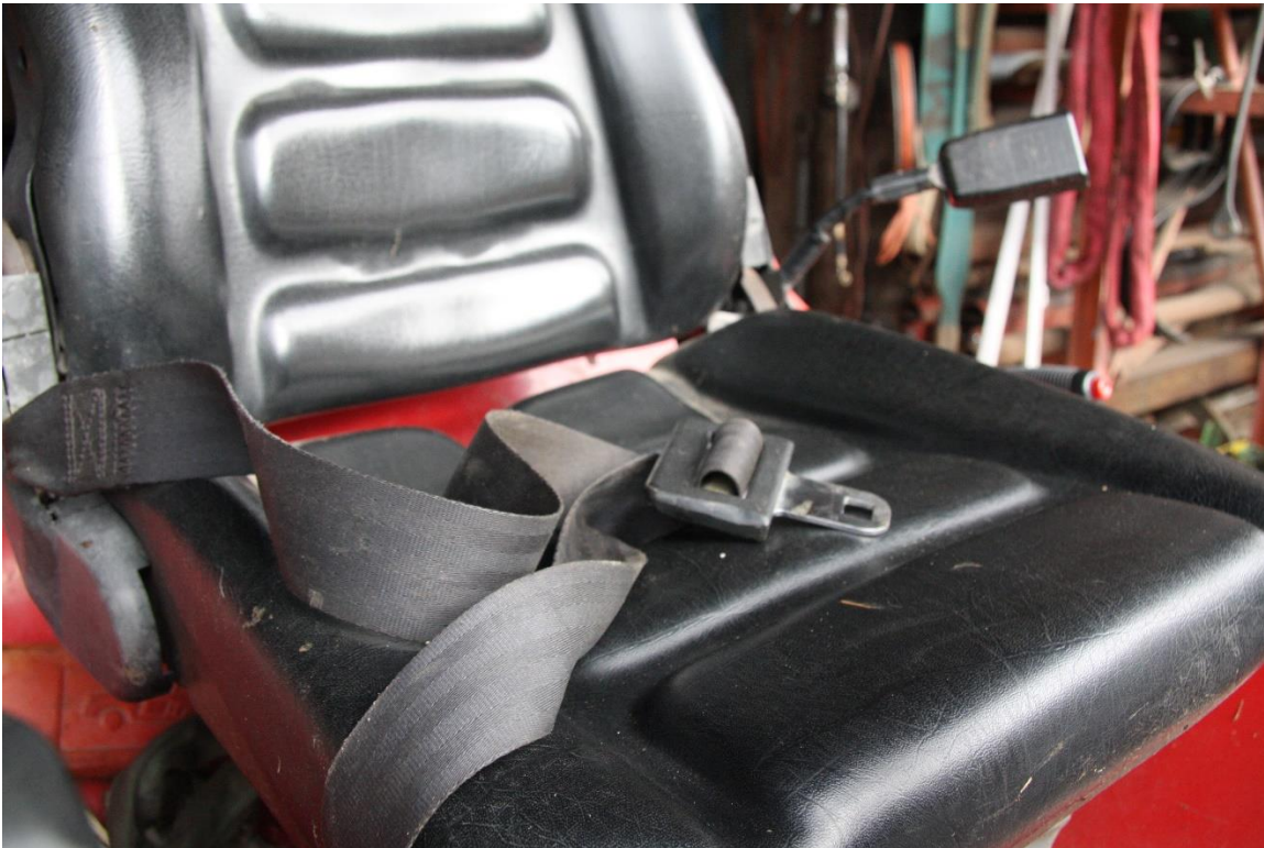
Statische Sicherheitsgurten sind wartungsarm und kaum störungsanfällig, jedoch umständlich bei der Benützung durch verschiedene Personen (Bild: BUL)
