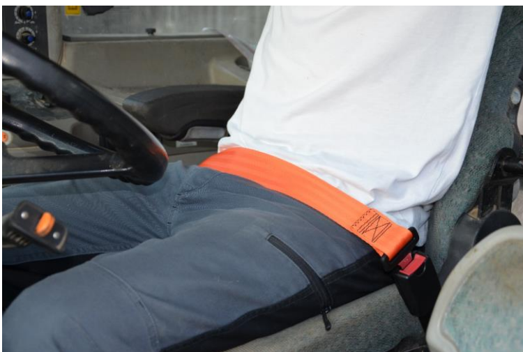
Gurten mit ALR-Retraktoren sichern die Person in einer fixen Position (Bild: BUL)
